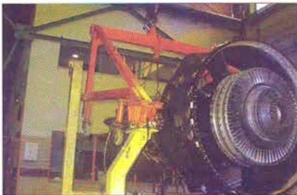
(در مرحله بعد جهت دسترسی به ماجول مورد نظر (ماجول ۷) می بایست ماجولهای جلوتر یعنی LP Compressor و IP Compressor از موتور جدا می شد در این تصویر ماجول IP در جلوی موتور دیده می شود)
